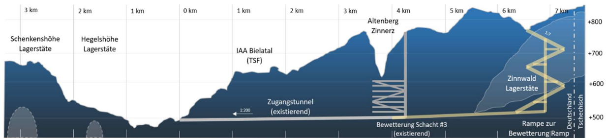
Abbildung 9: Geplante und bereits vorhandene Auffahrungen mit Streckenniveaus im Vorhabengebiet (Zinnwald / Falkenhain) mit Ausdehnung der Lagerstätte Zinnwald
